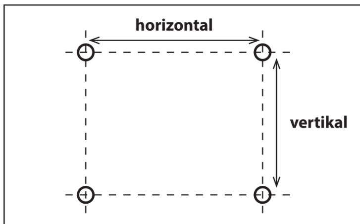
Um die Lochabstände des Monitors zu ermitteln, müssen die horizontalen und vertikalen Abstände der Gewindelöcher auf der Monitorrückseite gemessen werden.
